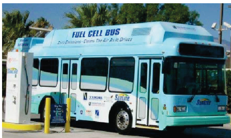
Rys. 15. Autobus Thor Industries, Inc. Thunder Power (2002) na ogniwo paliwowe na sprężony wodór, 75 kW, zasięg 320 km, 26 pasażerów, system PEMFC Fig. 15. The Thor Industries, Inc. Thunder Power bus (2002) on the fuel cell and compressed hydrogen, 75 kW, the range: 320 kms, 26 passengers, the PEMFC system
